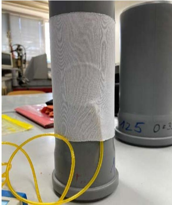
SI. 13. Pico Press senzor ispod uzorka prilikom ispitivanja
