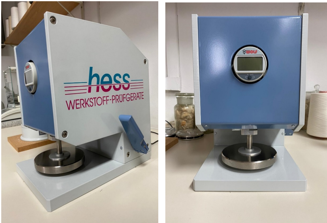
Sl. 11. Debljinomjer Hess MBV GmbH
