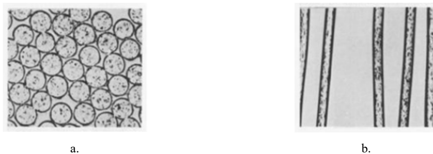
Slika 2. Poliestersko vlakno pod optičkim mikroskopom: a. Poprečni , b. Uzdužni presjek [5]
