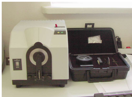
Slika 17. Remisijski spektrofotometar Spectraflash SF 300 (Datacolor)
