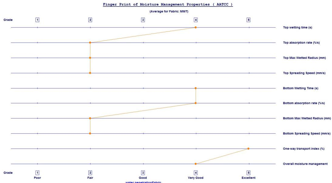
Slika 26. "Fingerprint" poliesterske tkanine nakon alkalne hidrolize (PET-AH)
