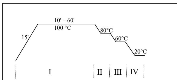
**Slika 15.** Shematski prikaz postupka alkalne hidrolize poliestera
