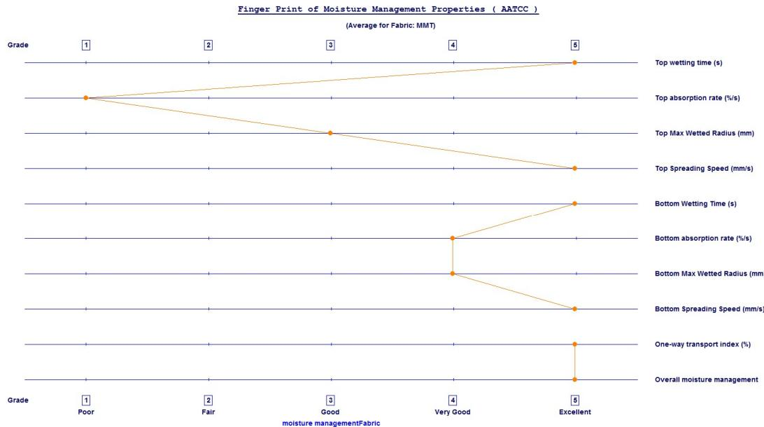
Slika 27. "Fingerprint" poliesterske tkanine nakon hidrolize enzimima pripremljenim u laboratoriju (PET-EH)
