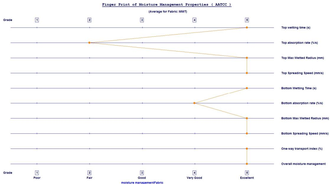
Slika 28. "Fingerprint" poliesterske tkanine nakon hidrolize komercijalnim lipazama (PET-LH)
