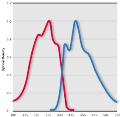
Slika 11. Apsorpcijski ( $A_{\max} = 375 \text{ nm}$ ) i emisijski ( $E_{\max} = 437 \text{ nm}$ ) spektar optičkog bijelila [39]
