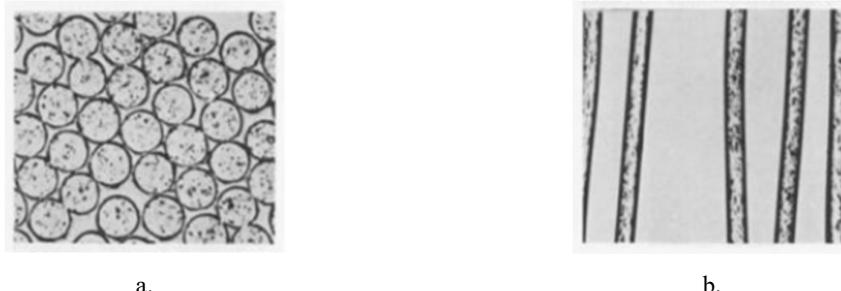
**Slika 2.** Poliestersko vlakno pod optičkim mikroskopom: a. Poprečni, b. Uzdужni presjek [5]
