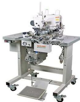
**Slika 5.** Šivaći automat za porubljivanje hlača [16]
