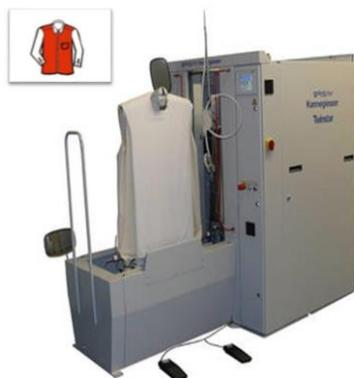
**Slika 6.** Stroj za tunelno glaćanje [17]
