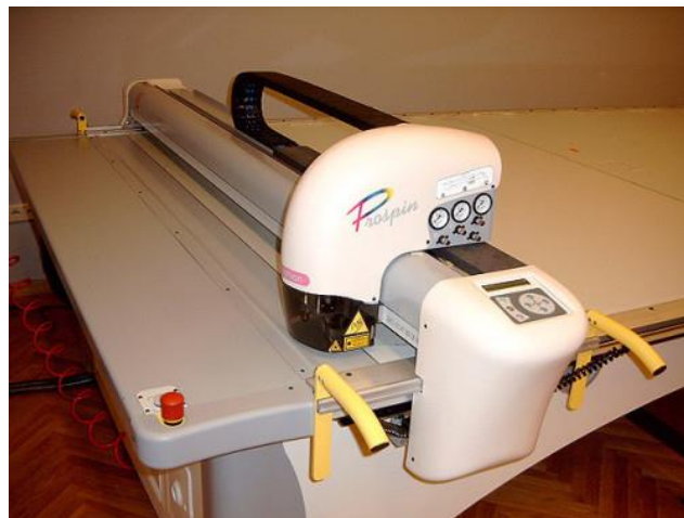
Slika 3. Agregat za iskrojavanje Lectra, Bordeaux – Cestas, France, PROSPINFASHION 72
