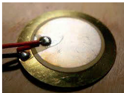
Slika 9. Piezoelektrički disk ugrađen u obuću.
