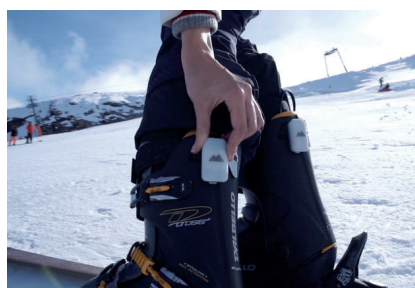
Slika 18. Pancericice sa ugrađenim sensorima pokreta.
