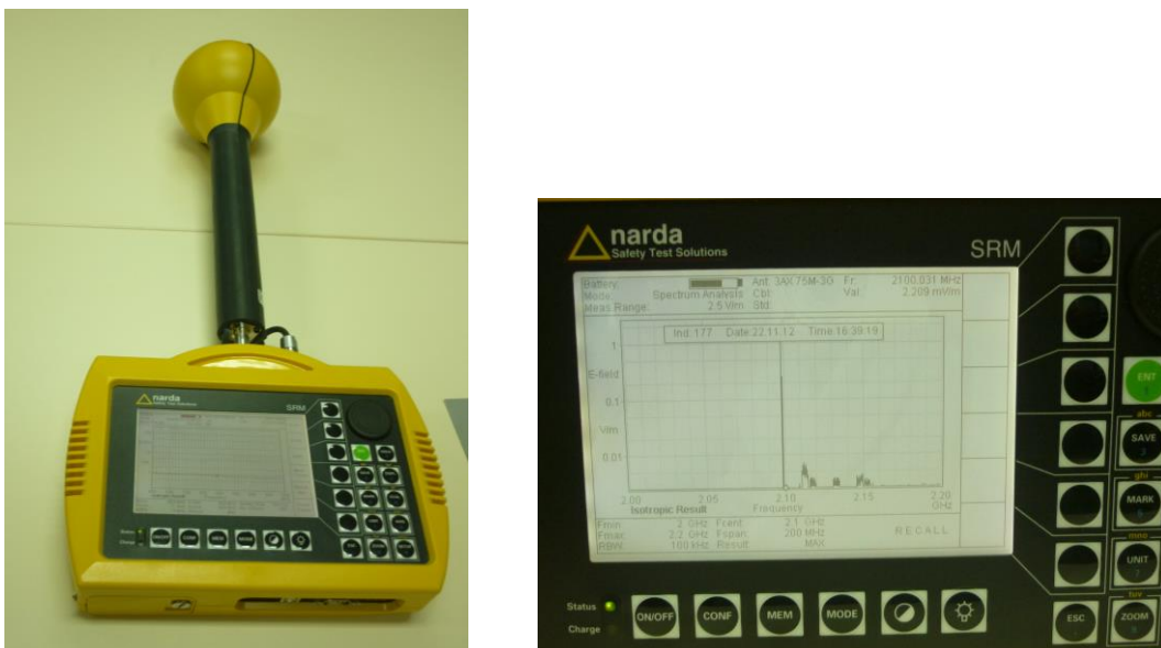
Slika 3.28. Mjerni instrument NARDA SRM 3000
