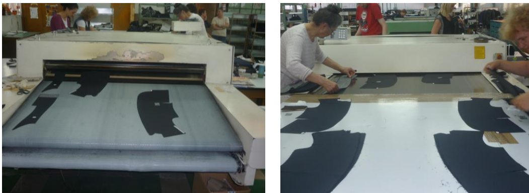
Slika 3.11. Kontinuirani stroj za frontalno fiksiranje Meyer RPS JUNIOR
