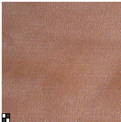
Slika 3.1. Međupodstavna tkanina s bakrenim nanosom, MP1 otkana u platnu (P1/1)
