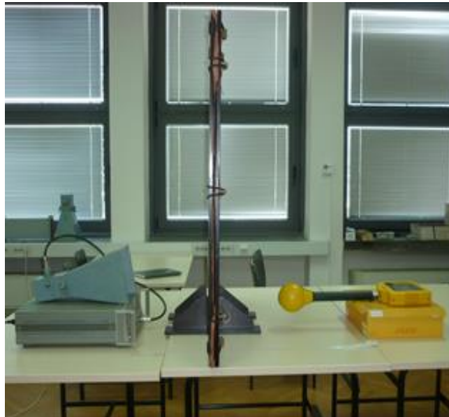
Slika 3.26. Mjerni postav za mjerenje zaštitnih svojstava tekstilnih uzoraka
