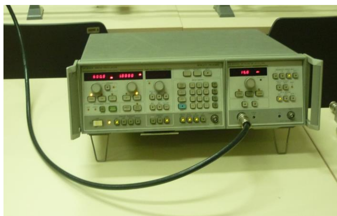
Slika 3.29. Generator signala HP 8350 B
