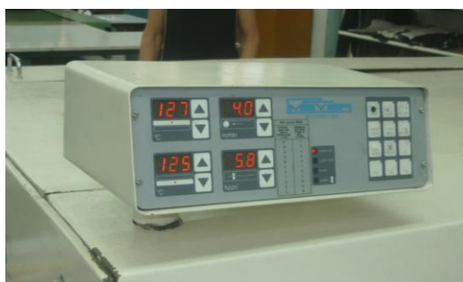
Slika 3.12. Kontrolna ploča na stroju za frontalno fiksiranje Meyer RPS JUNIOR
