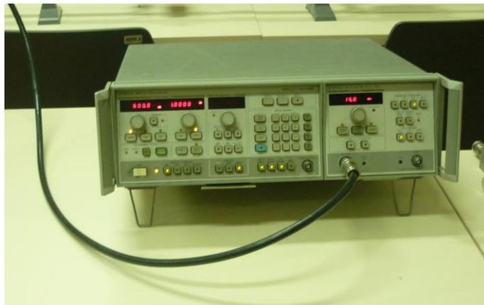
**Slika 3.29.** Generator signala HP 8350 B
