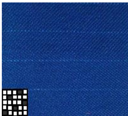
Slika 3.4. Zaštitna tkanina s inox vlaknima, MP4 otkana u atlasu (A1/4 (2))
