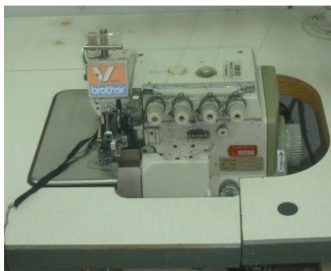
Slika 3.13. Specijalni šivaći stroj za obamitanje Brother EF4 V71 / V72
