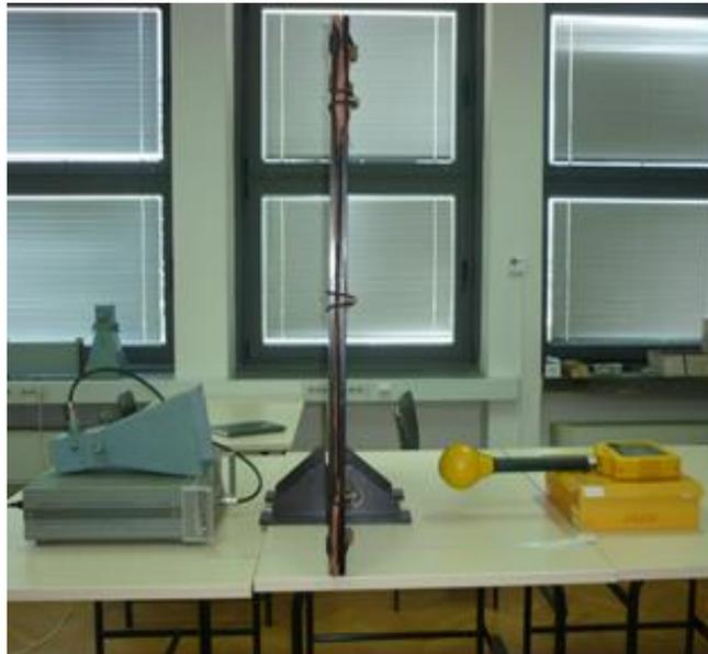
**Slika 3.26.** Mjerni postav za mjerenje zaštitnih svojstava tekstilnih uzoraka
