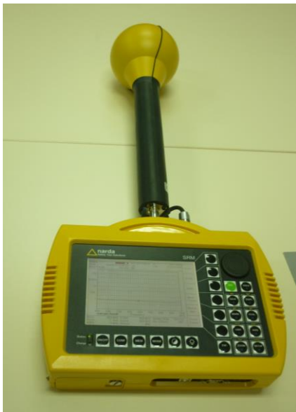
Slika 3.28. Mjerni instrument NARDA SRM 3000
