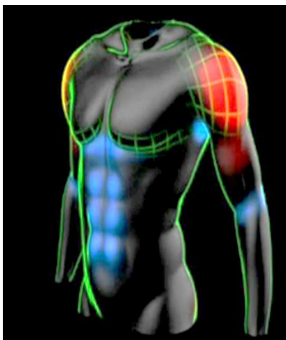
Sl. 57 Područje zagrijavanja ljudskog torza-crveno područje označava mjesto najjačeg zagrijavanja kože, a plava područja najvećeg sakupljanja izlučenog znoja, IZVOR: Outlast Technology
