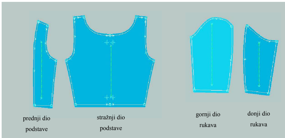
Sl. 31 Prikaz modeliranih krojnih dijelova podstave varijante modela letačke vjetrovke primjenom CAD sustava Lectra Systemes i programskog paketa Modaris
