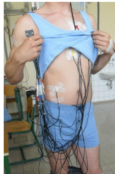
Sl. 54 Fotografski prikaz ispitanika sa učvršćenim sensorima za utvrđivanje fizioloških parametara MSR 12 mjernim uređajem
