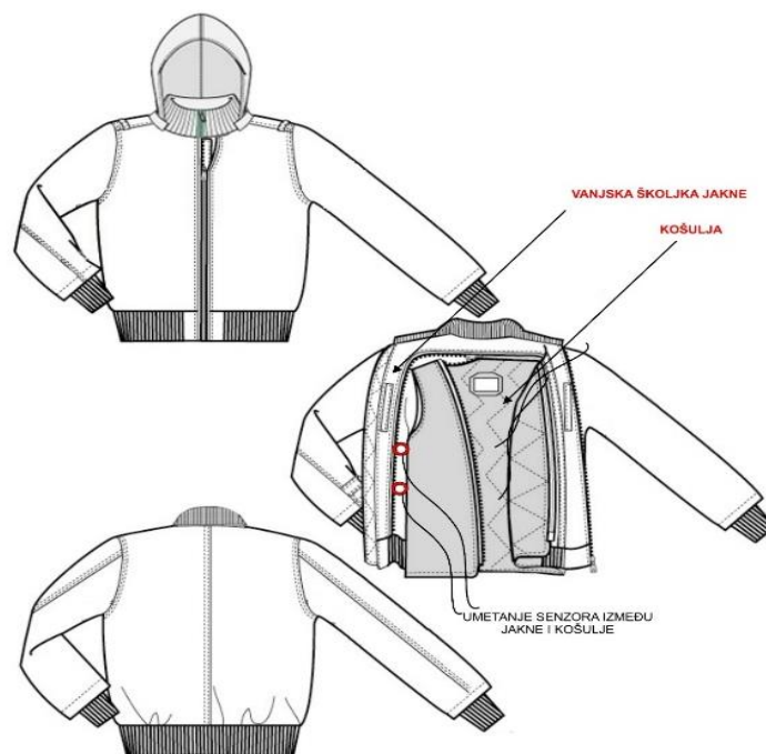
Sl. 55 Položaj i umetanje temperaturnih senzora kako bi se utvrdile temperaturne varijacije mikroklimatskog područja odjevnog predmeta
