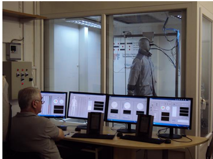
Sl. 21 Prikaz termalnog manekena smještenog u klima komori s mogućnošću kontrole parametara okoliša
