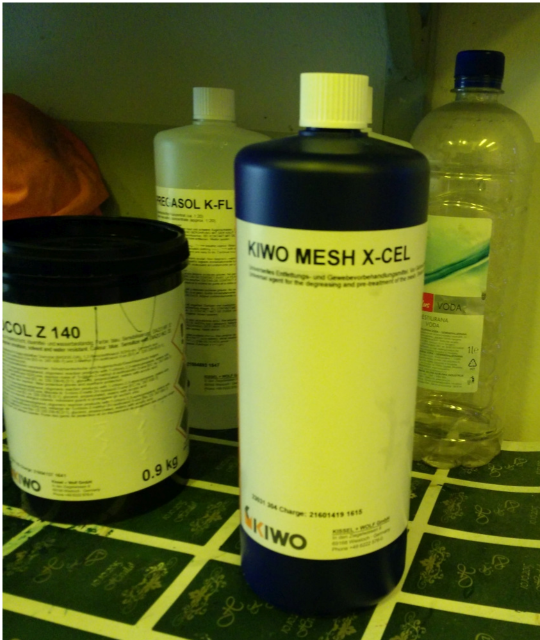
Slika 17: Kiwo mesh x-cel, odmaščivač sita
