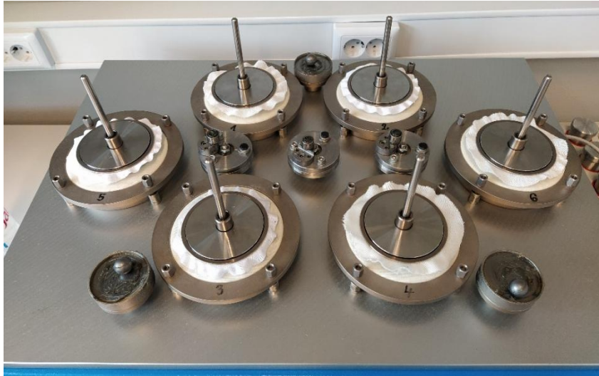
Slika 19. Epruvete načinjene za ispitivanje sklonosti nastanku površinskog pilinga
