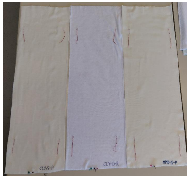
Slika 244. Epruvete načinjene za ispitivanje dimenzijske stabilnosti
