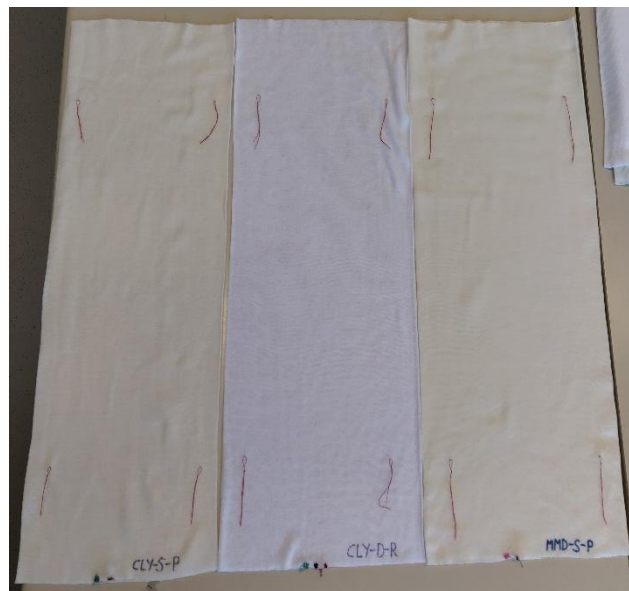
Slika 244. Epruvete načinjene za ispitivanje dimenzijske stabilnosti
