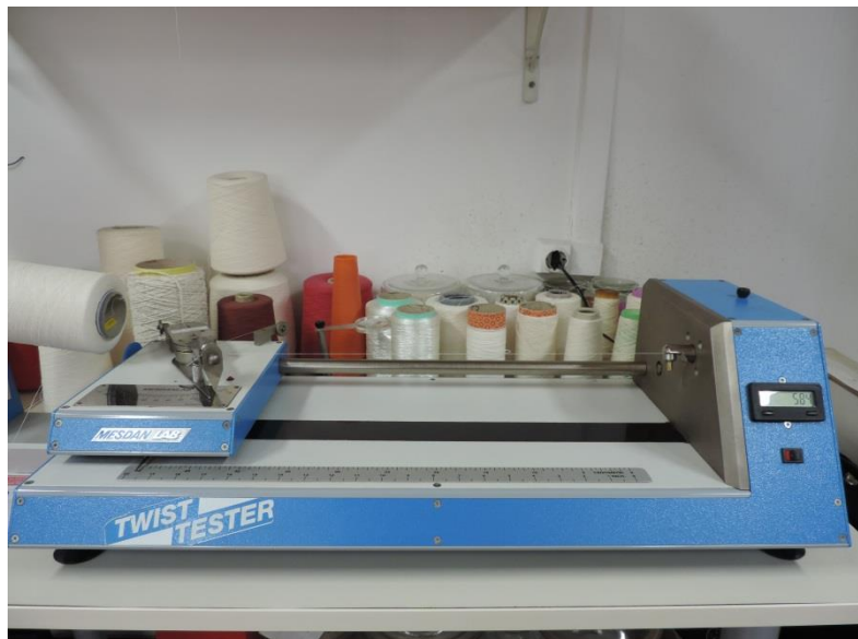
SI. 35. Torziometar Twist tester za određivanje uvojitosti pređe
