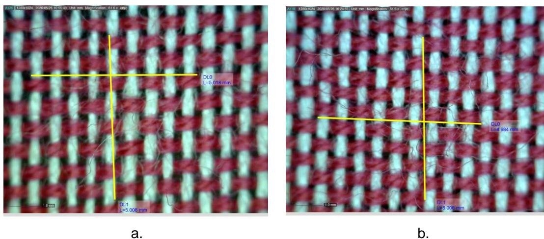
**Sl. 37.** Mjerenje gustoće niti osnove i potke na stroju računalnom analizom slike : a. uzorak 1, b. uzorak 2
