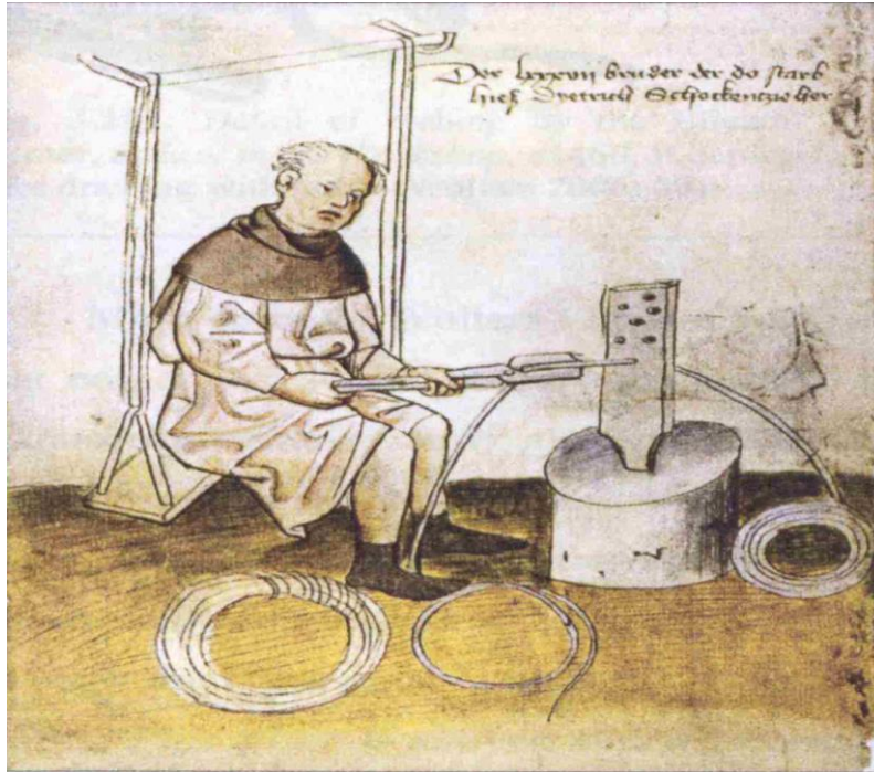
Slika 5: Prva ilustracija proizvodnje žice tehnikom izvlačenja [22]
