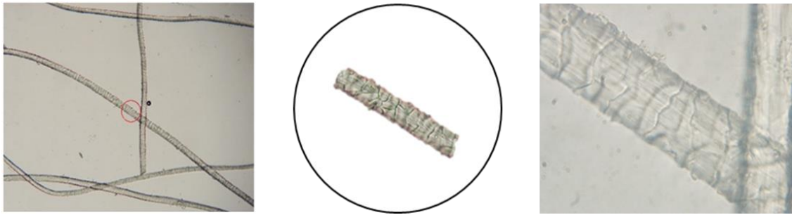
Slika 23. Mikroskopski izgled vlakana PP (x100 i x1000)
