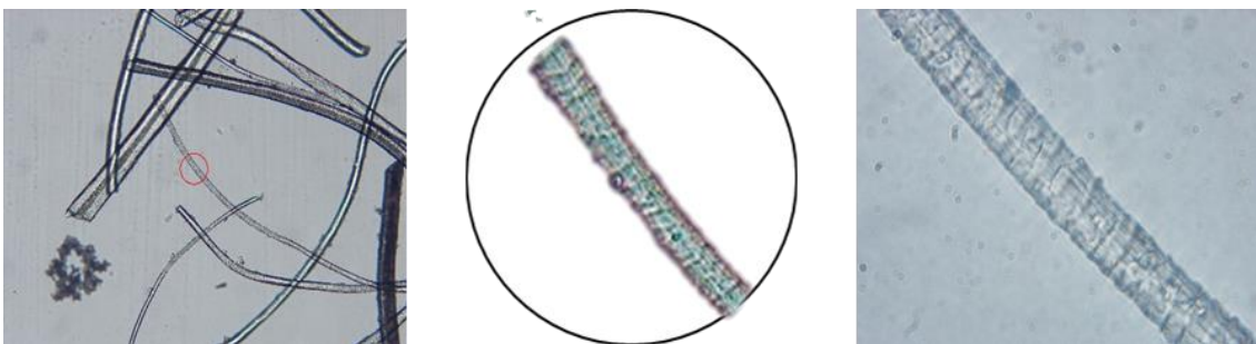
Slika 25. Mikroskopski izgled vlakana CP (x100 i x1000)
