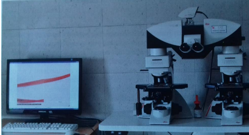
Slika 11. Komparativni mikroskop za vještačenje tekstilnih vlakana (Izvor slike: Modly D., Mršić G.: “Forenzika: Suvremene kriminalističke teorije“)
