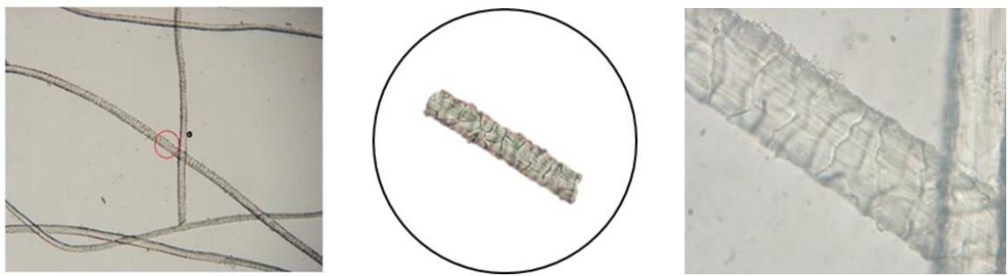
Slika 23. Mikroskopski izgled vlakna PP (x100 i x1000)
