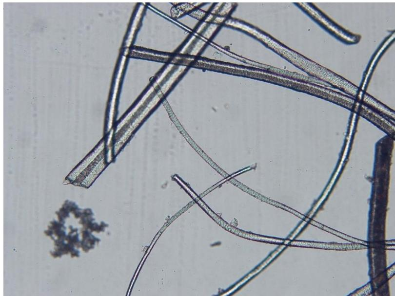
Slika 22. Mikroskopski izgled vlakana u uzorku CP (x100)
