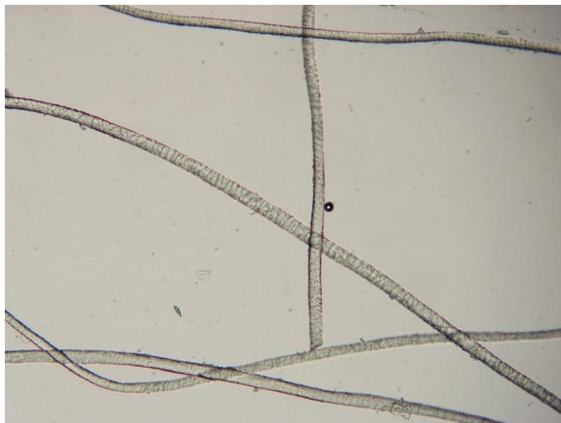
Slika 20. Mikroskopski izgled vlakana u uzorku PP (x100)
