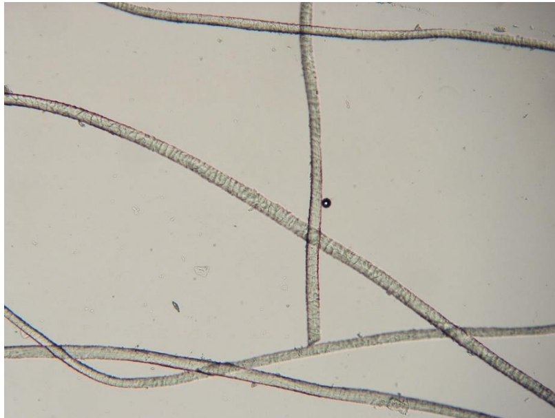
Slika 20. Mikroskopski izgled vlakana u uzorku PP (x100)
