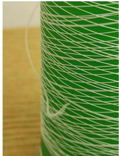
Sl. 40: Teksturirana multifilamentna PA
