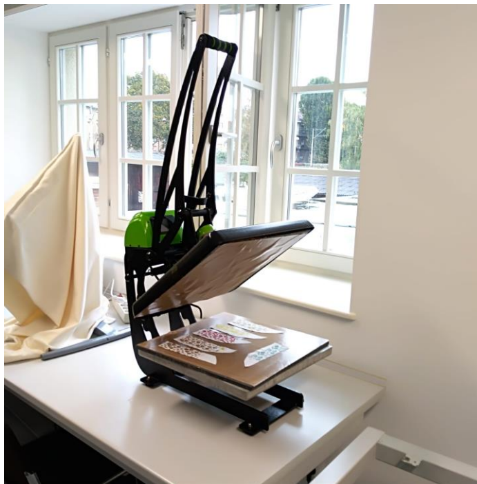
Slika 10. Prikaz kontaktno fiksiranja vrućim zrakom u laboratoriju
