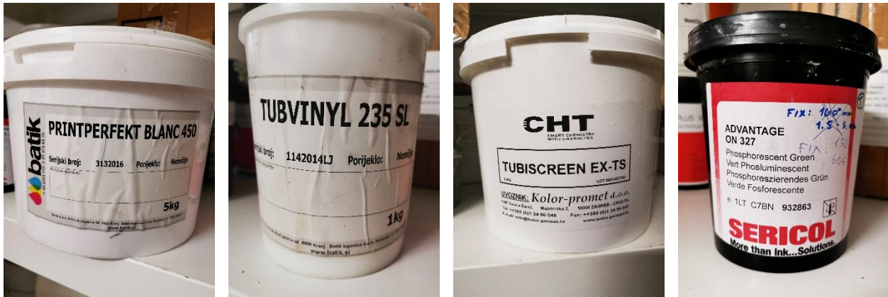
Sl.13. Temeljne tiskarske paste; od lijeva prema desno: pokrivna, transparentna, bubreća i tiskarska pasta sa fosforescentnim pigmentima.
