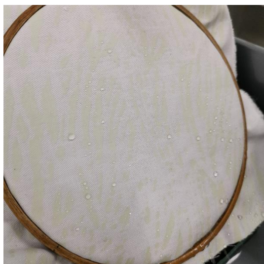
Sl.23. Prikaz vodoodbojnosti test 3.
