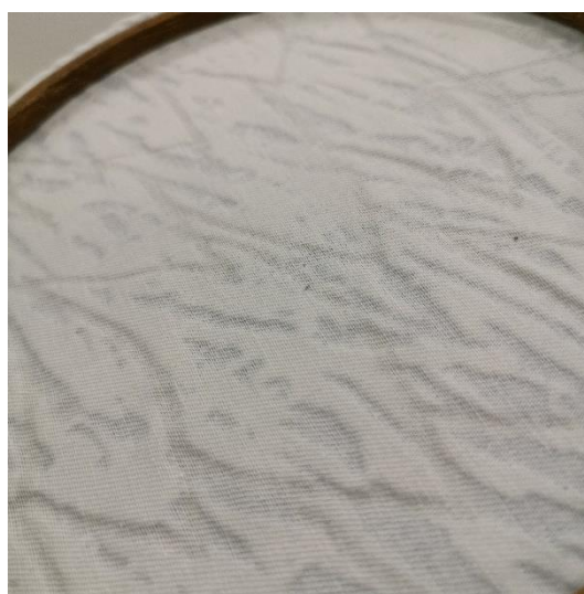
Sl.21. Prikaz vodoodbojnosti test 1.
