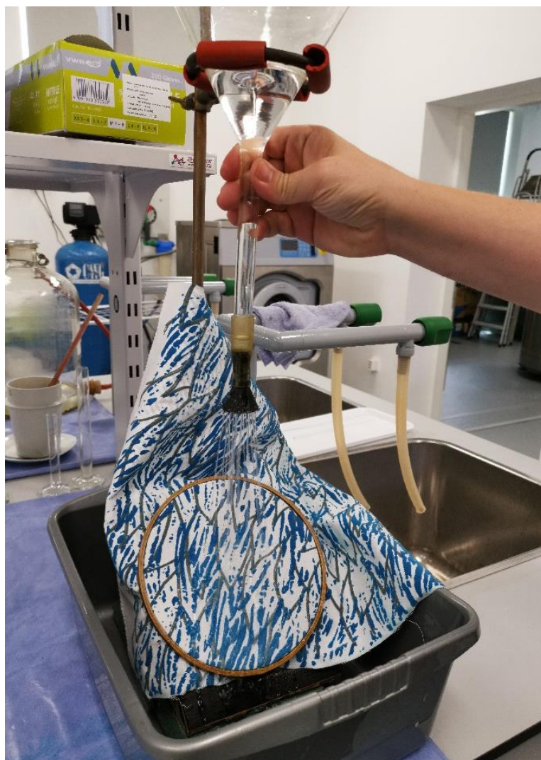
Sl.20. Ispitivanje Spray testom.
