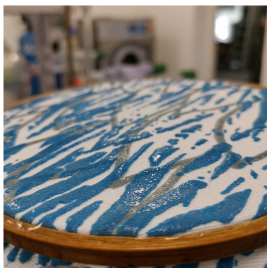
Sl.21. Prikaz vodoodbojnosti test 1.
