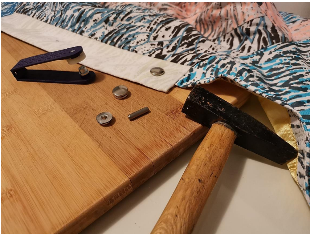
Sl.28. Postavljanje metalnih drukera.
