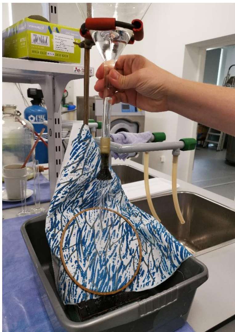
Sl.20. Ispitivanje Spray testom.
