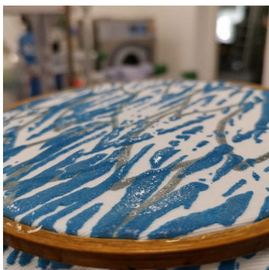
Sl.21. Prikaz vodoodbojnosti test 1.
