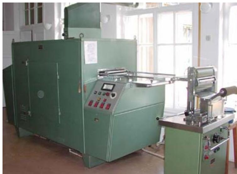
**Slika 19:** Rastezni sušionik s foulardom, Benz
