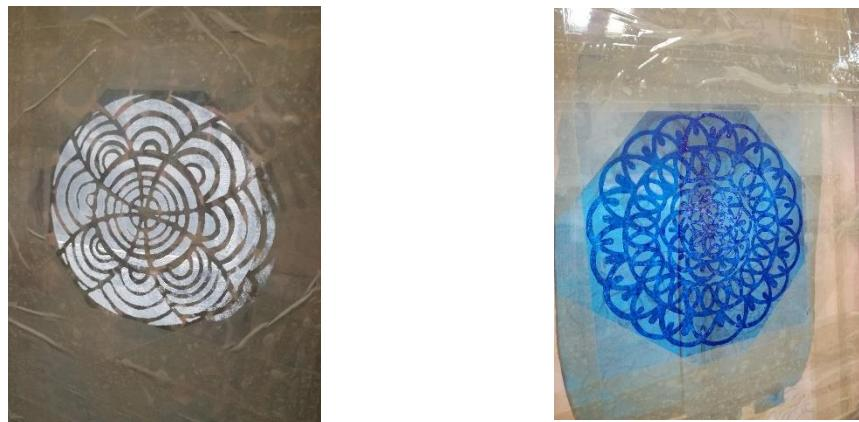
**Slika 13:** vidljivi uzorci na šabloni gdje se tiskalo sa plavom i bijelom pastom
