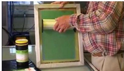
**Slika 7:** Premazivanje sita fotoemulzijom
