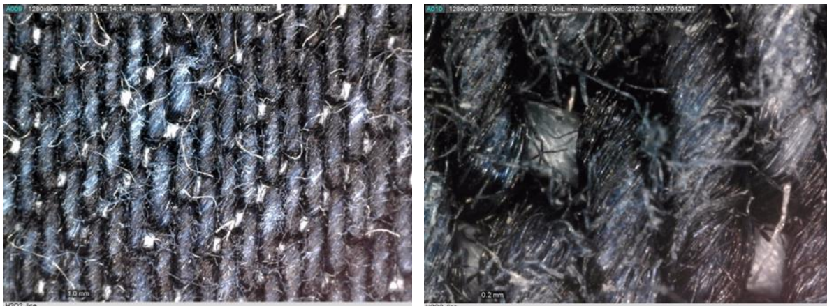
Slika 46: Uzorak džins tkanine obezbojene s H_2O_2 - lice tkanine uz različita povećanja a) 53.1 X; b) 232.2 X
