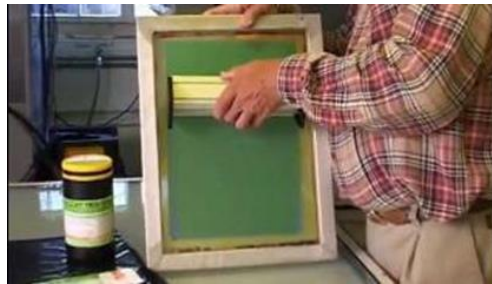
Slika 7: Premazivanje sita fotoemulzijom
