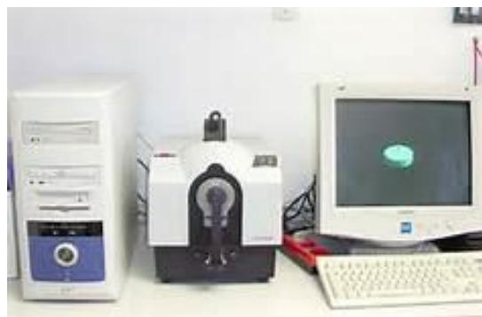
**Slika 23:** Remisijski spektrofotometar Spectraflash SF 300, tt. Datacolor
