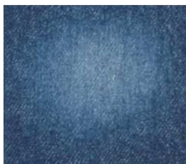
Slika 8: Džins obrađen vulkanskim kamenom i KMnO_4
