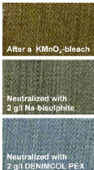
Slika 9: Namakanje kamena s KMnO_4 u tumbleru/bubnju stroja za obradu džinsa
