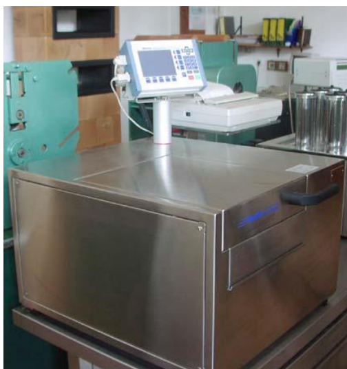
Slika 13: Uređaj za oplemenjivanje i bojadisanje, Turbomat P4502, Mathis
