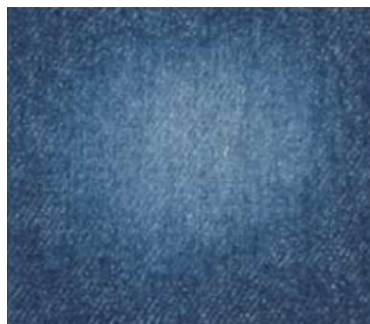
Slika 8: Džins obrađen vulkanskim kamenom i KMnO_4
