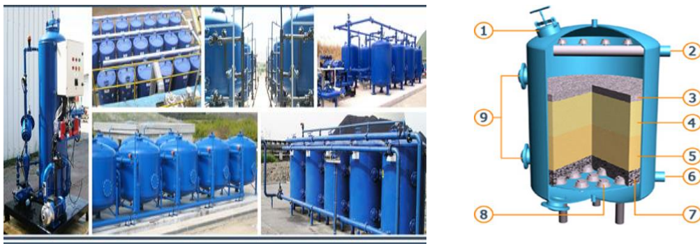
Slika 22. Izgled filtracijsko adsorpcijskih uređaja [43]
