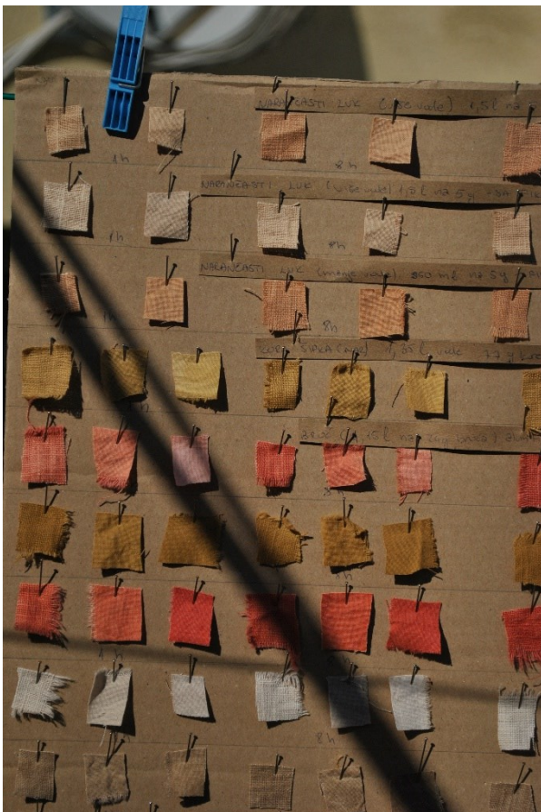
Slike 47 i 48: Uzorci izloženi svjetlu [29]
