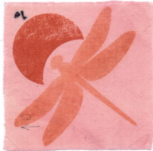
Slika 23. Uzorak predobrađen KAl(SO_4)_2 \cdot 12H_2O , bojadisan i tiskan – BROĆ
