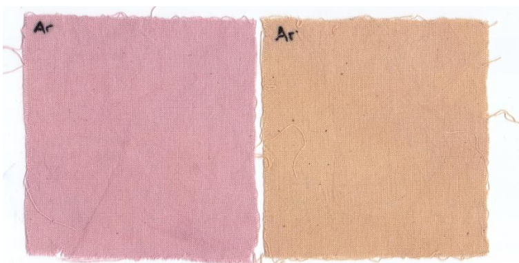
Slika 12. Uzorak predobrađen plazmom argonom nakon bojadisanja u broću i luku
