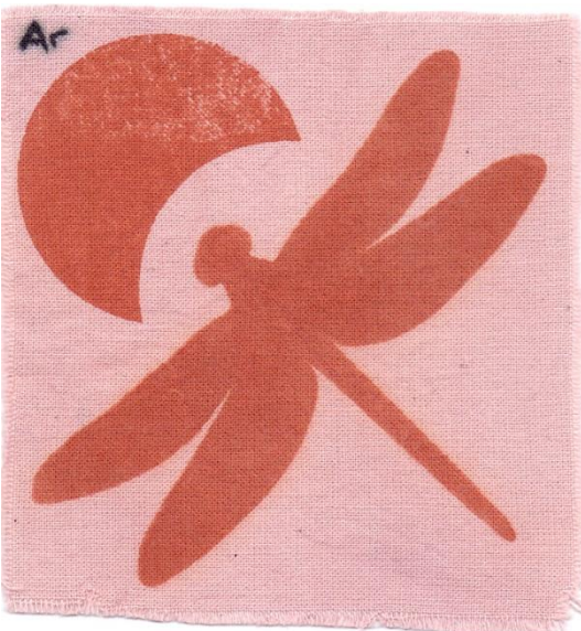
Slika 24. Uzorak predobrađen argonovom plazmom, bojadisan i tiskan – BROĆ
