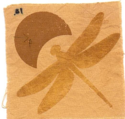
Slika 19. Uzorak predobrađen  $KAl(SO_4)_2 \times 12H_2O$ , bojadisan i tiskan – LUK
