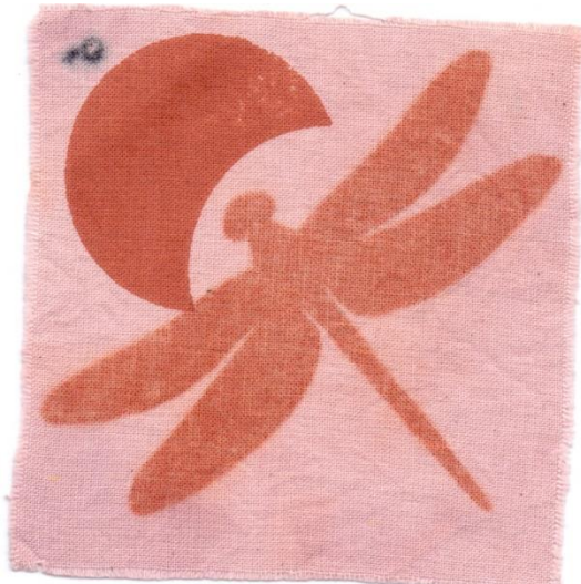
Slika 25. Uzorak predobrađen kisikovom plazmom, bojadisan i tiskan – LUK
