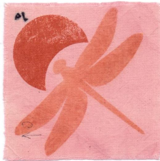
Slika 23. Uzorak predobrađen  $KAl(SO_4)_2 \times 12H_2O$ , bojadisan i tiskan – BROĆ
