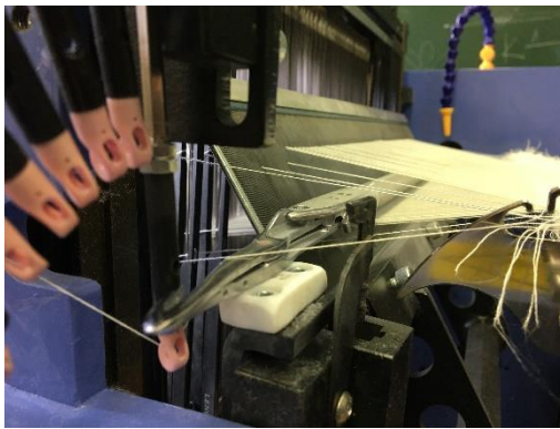
Sl. 20. a) spuštenu dodavač potke u trenutku tkanja uzoraka, b) izrada uzoraka
