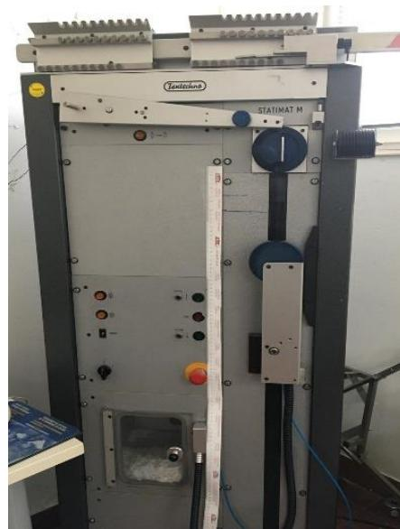
Sl. 10. Dinamometar sa stezaljkama za ispitivanje pređe
