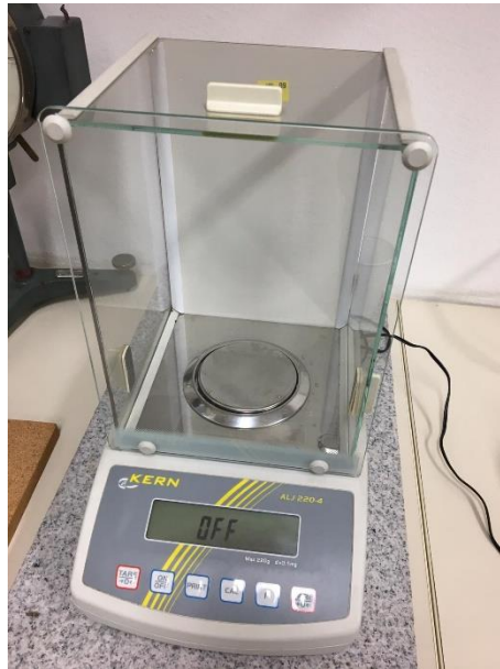
Sl. 13. Uređaj za određivanje mase KERN ALJ 220-4
