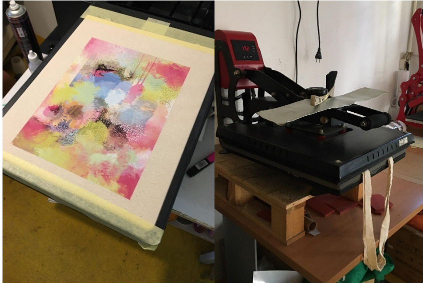
Slika 46: Gotov uzorak otisnut na torbi i fiksiranje uzorka na preši
