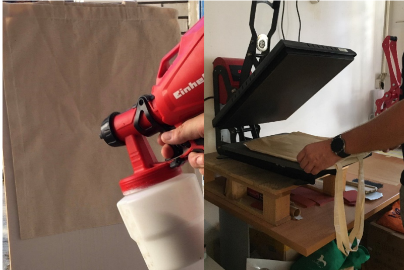
Slika 42: Priprema tkanine vezivnim sredstvom i glačanjem prešom
