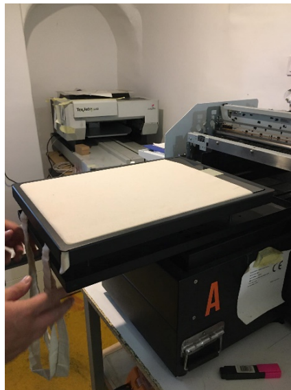
Slika 43: Tkanina postavljena na ploču, učvršćena okvirom
