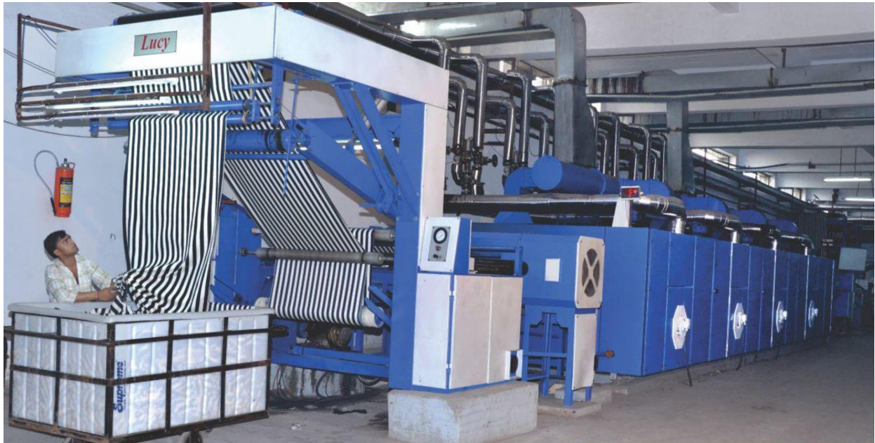
Slika 30. Primjer kontinuirane sušare tkanina (IZVOR: https://www.lucyengineering.com/stenter-machine.html )
