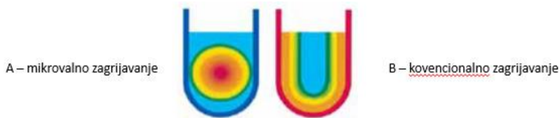
Slika 13: Prikaz prijenosa topline mikrovalnim zračenjem i konvencionalnim zagrijavanjem (IZVOR: Banu Yeşim Büyükkakinci, 2011.)
