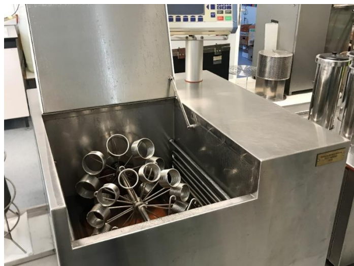
Slika 11: Laboratorijski aparat za mokro oplemenjivanje i bojadisanje, Polycolor
