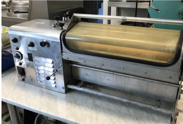
Slika 8: Laboratorijski aparat džiger
