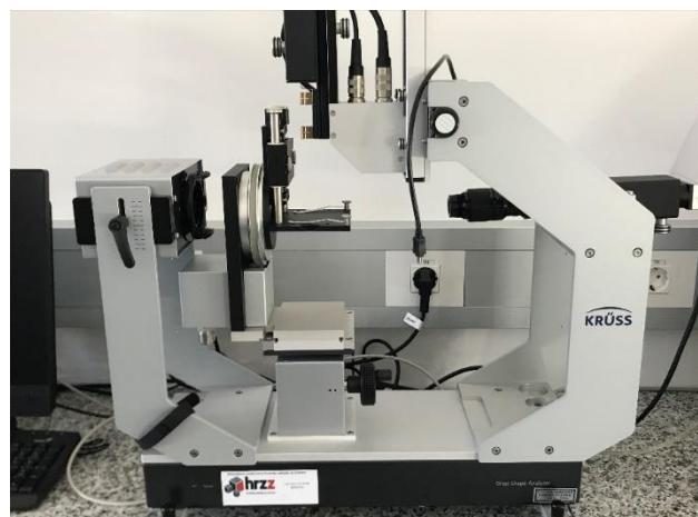
**Slika 16:** Uređaj za mjerene kontaktnog kuta kapljice
