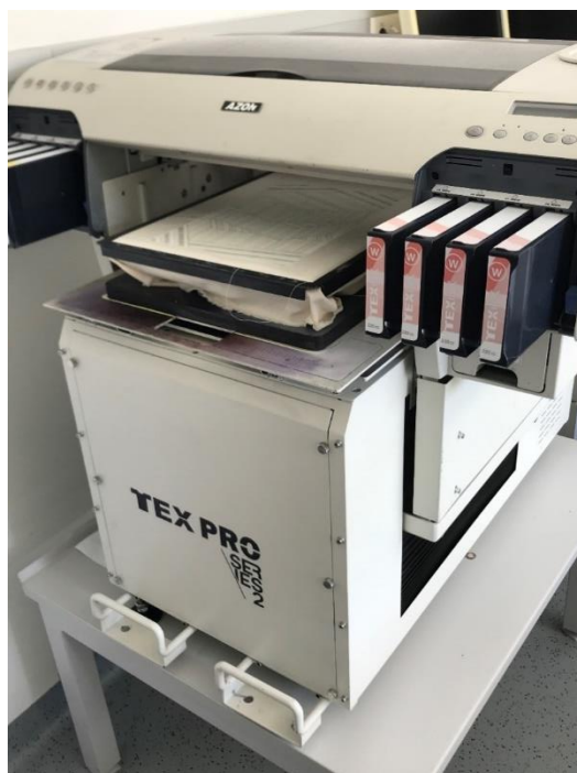
Slika 10: Azon Tex Pro stroj za digitalni tekstilni InkJet tisak
