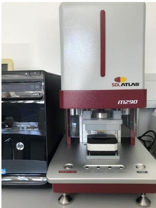
**Slika 15:** Uređaj za ispitivanje sposobnosti upravljanja vlagom
