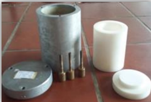
Sl.30. Slika autoklava u kojemu su provedene solvotermalne reakcije
