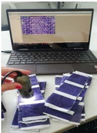
Slika 46. Mjerenje uzoraka pomoću Dino-Lite digitalnog mikroskopa
