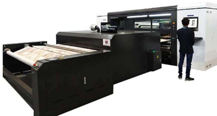
Slika 27. Tekstilni Ink Jet stroj Vega one
