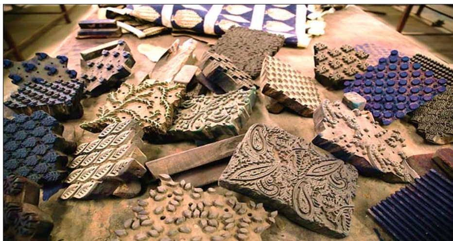
Slika 1. Blokovi ručni za tekstilni tisak (Indija)
