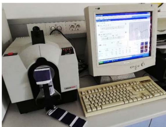
Slika 43. Remisijski spektrofotometar, Spectraflash SF 600 PLUS-CT, Datacolor
