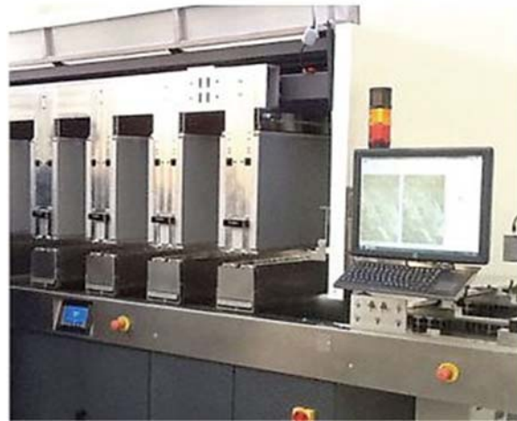
Slika 29. Tekstilni Ink Jet stroj KERAtex [16]
