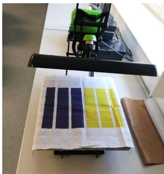
Slika 41. Fiksiranje vrućim zrakom pomoću termo preše
