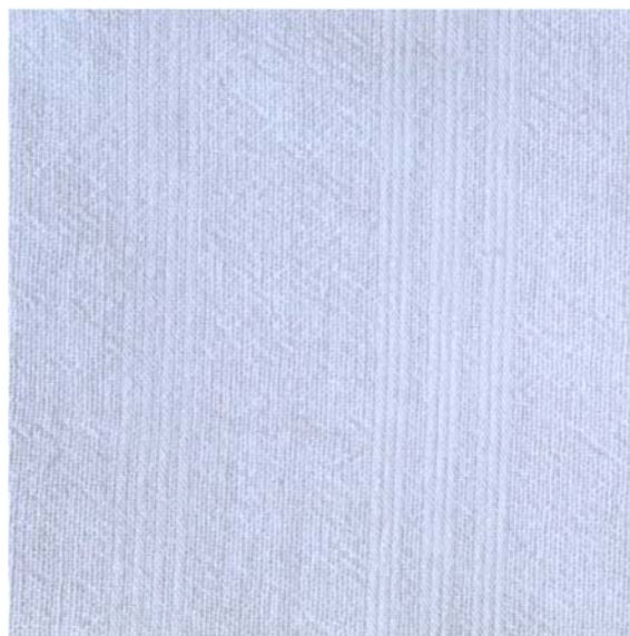
Slika 33. Optički bijeljeni uzorak platno veza 1:1 s uzorkom pruga
