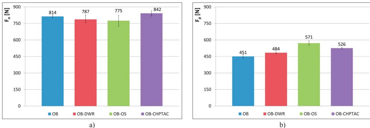
Sl.2 Prekidne sile optički bijeljene pamučne tkanine prije i nakon kationiziranja: a) po osnovi ( $F_o$ ), b) po potki ( $F_p$ )
