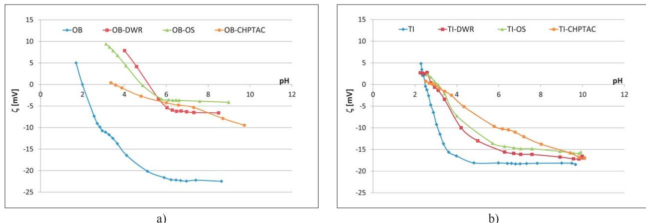
Sl.1 Zeta potencijal ( $\zeta$ ) pamučne tkanine prije i nakon kationiziranja u ovisnosti o pH elektrolita 0.001 M KCl:
