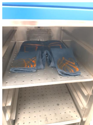
Slika 23. odjevni predmet pripremljen za sušenje i kondenzaciju
