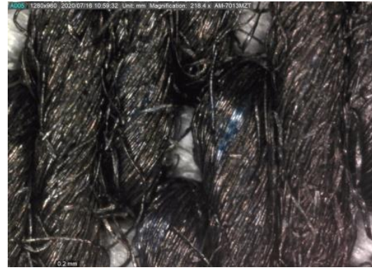
Slika 3. Džins tkanina pod uvećanjem od a) 55 X i b) 235 X
