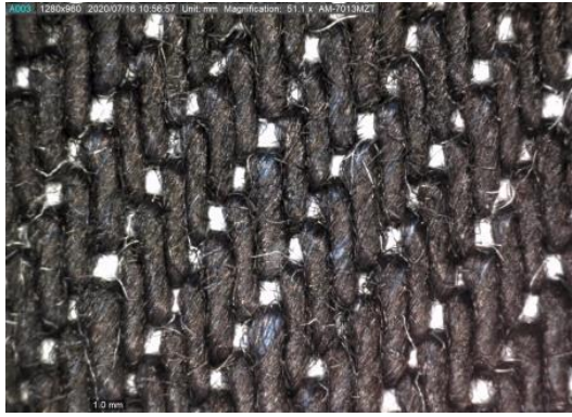
Slika 3. Džins tkanina pod uvećanjem od a) 55 X i b) 235 X
