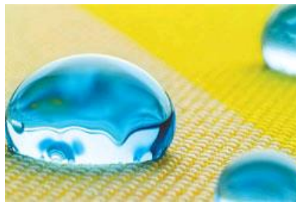
Slika 41. Napetost površine – kap na tekstilnom materijalu [59]
