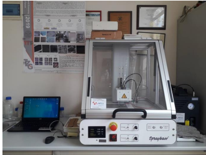
Slika 22. Uređaj za elektroispredanje iz polimerne taline, Spraybase®.
