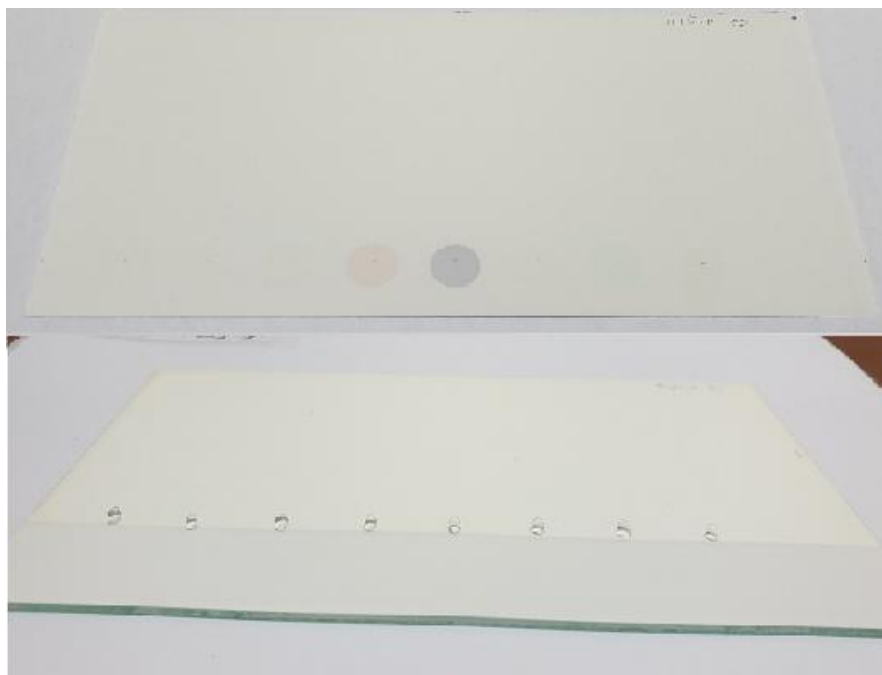
Slika 10. (Gornja slika) Pločica koja ne sadrži hidrofobni sloj i (Donja slika) pločica koja sadrži hidrofobni sloj.
