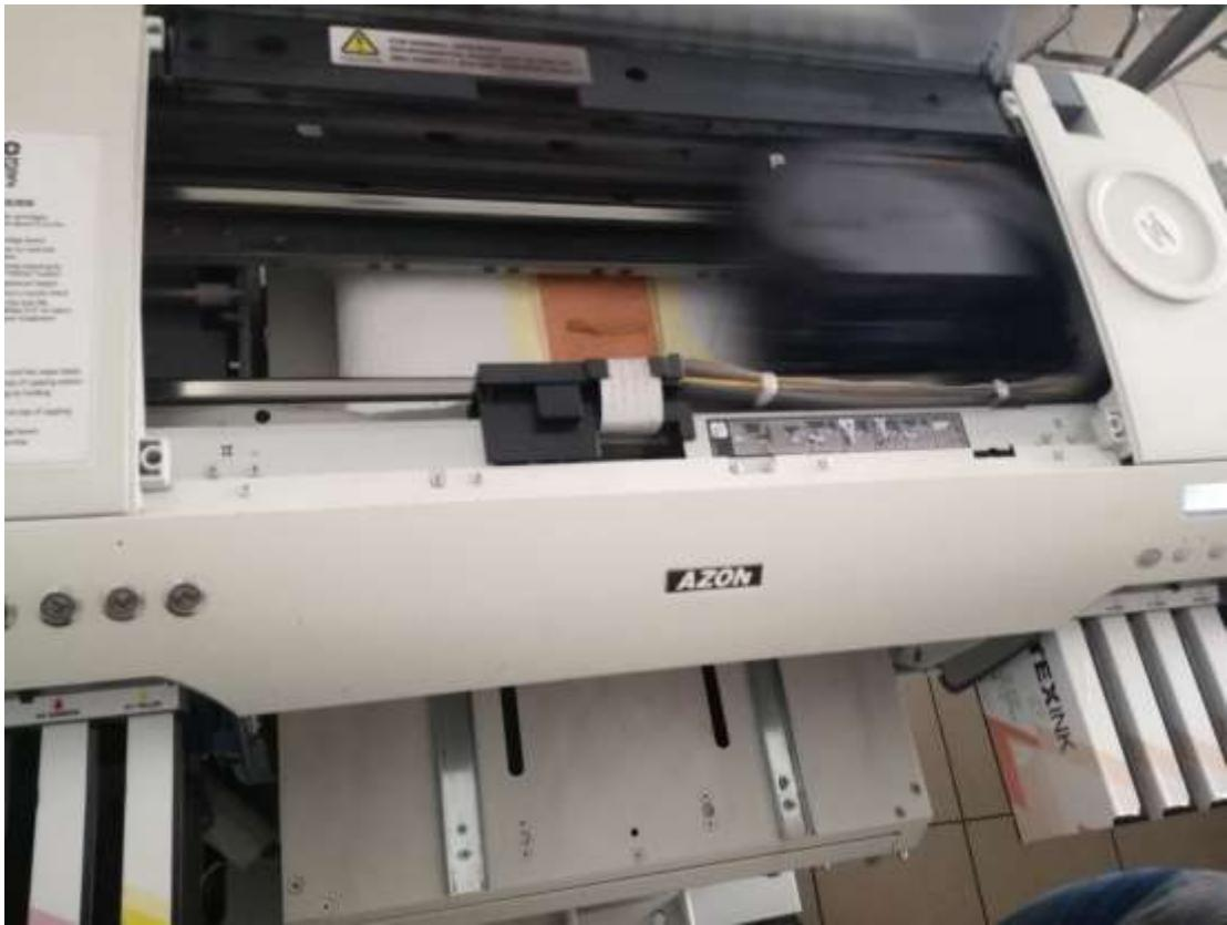
**Slika 46:** Pripremljen odjevni predmet za digitalni tisak.
