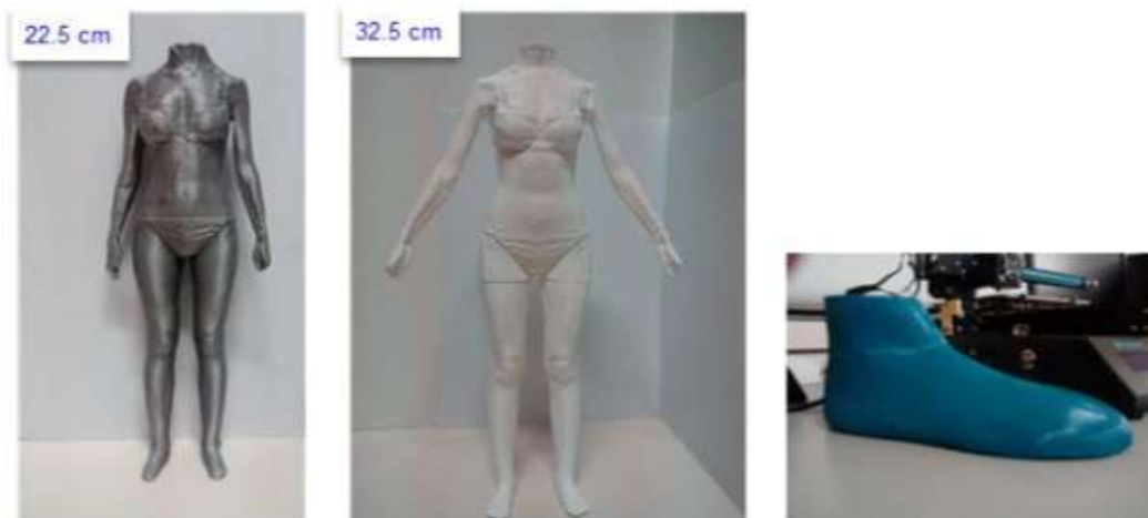
Sl.19. 3D tiskani modeli: 1) skalirani model tijela; 2) skalirani model tijela s različitim položajima ruku; 3) model stopala. [19]
