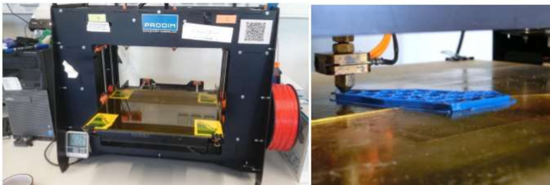
Sl.18. Orcabot XXL 3D pisac koji se koristi za ispis 3D tijela skaliranog ljudskog tijela i procesa ispisa [19]
