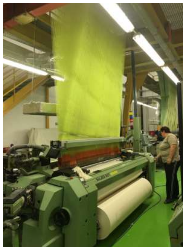
Slika 8 Tkalački strojevi (a. Listovni tkalački stroj; b. Źakardski tkalački stroj)
