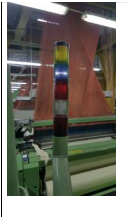
Slika 6 Indikator svjetlo za signalizaciju prekida osnove
