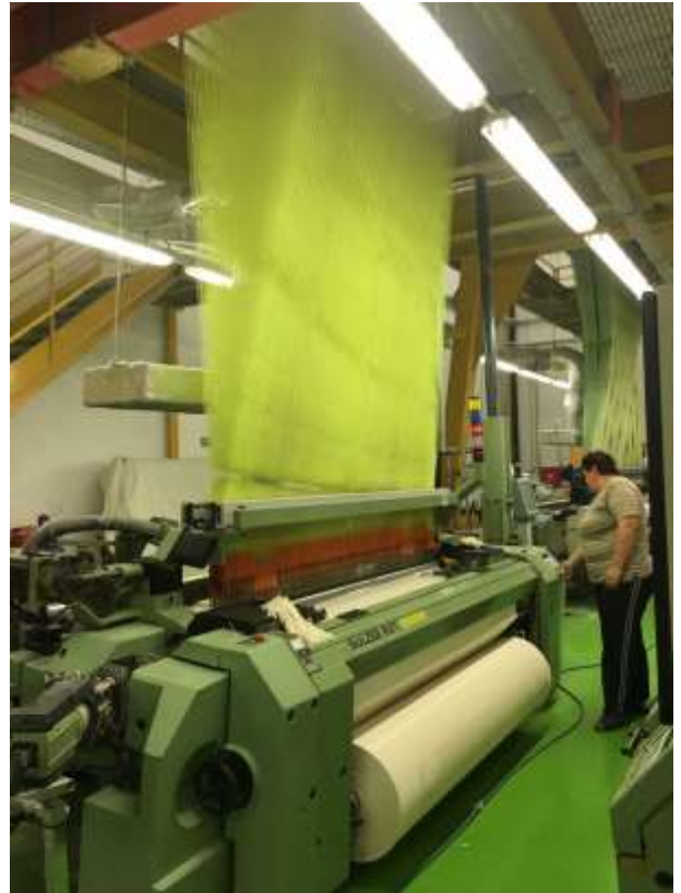
Slika 8 Tkalački strojevi (a. Listovni tkalački stroj; b. Žakardski tkalački stroj)
