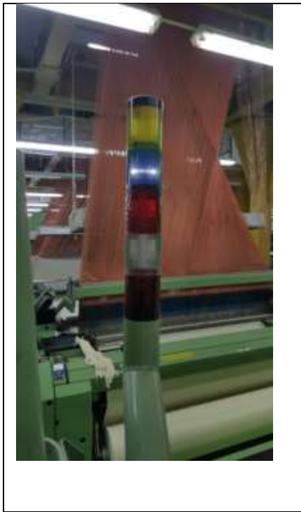
Slika 6 Indikator svjetlo za signalizaciju prekida osnove
