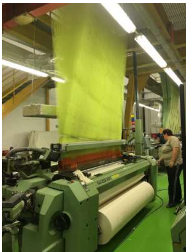
Slika 8 Tkalački strojevi (a. Listovni tkalački stroj; b. Žakardski tkalački stroj)
