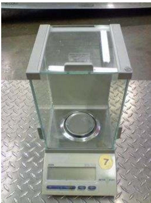
Sl. 22. Analitička vaga marke Mettler Toledo
