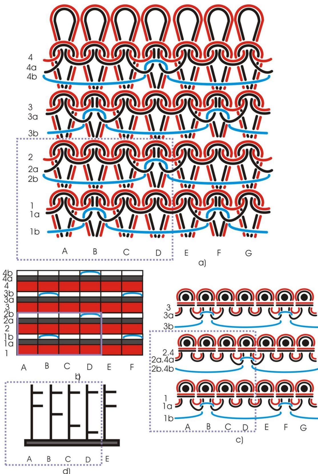
Slika 11. Vezno podstavni preplet 1+3: a) preplet, b) tehnička patrona, C) slijed niti u pojedinim redovima, d) raspored igala
