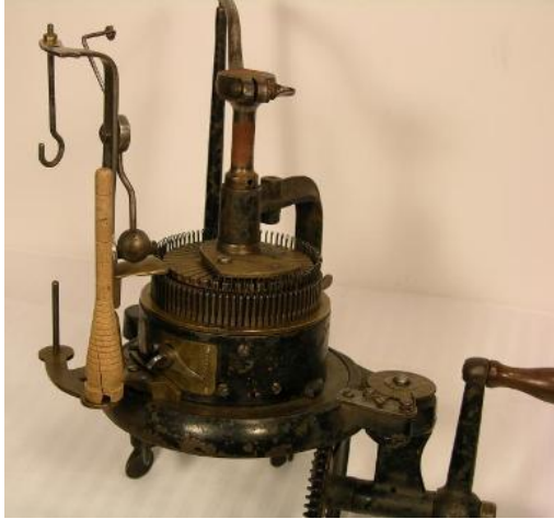
Slika 40.: Griswold-ov stroj za pletenje čarapa
